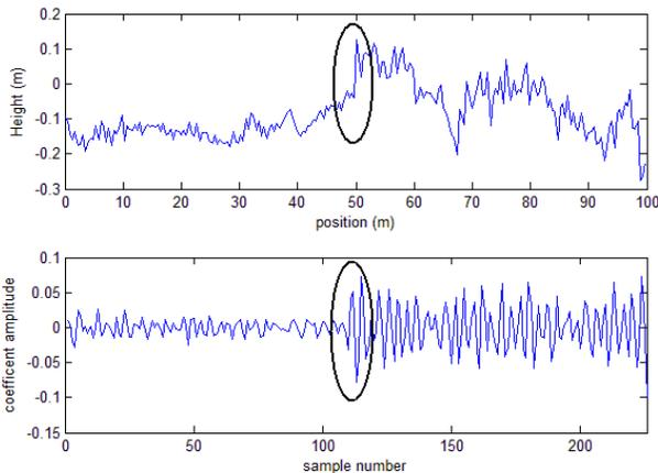
FIGURE 10. PROFILE WITH A CHANGE IN ROUGHNESS AND THE HIGH FREQUENCY WAVELET DECOMPOSITION DETECTING CHANGE
