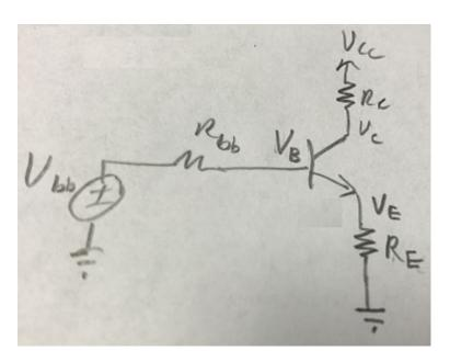
$$V_{bb} = I_E R_E + 0.7 + I_B R_{bb}$$
